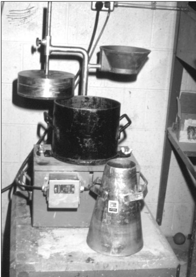
Figure 8.7. Modified Vebe apparatus
